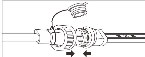
② 電源コードのカッピングナットをしっかりと締め付けてください。
