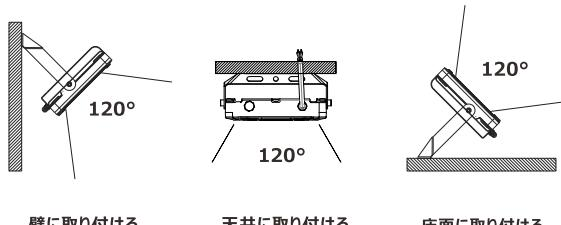
壁に取り付ける 120° 天井に取り付ける 120° 床面に取り付ける
