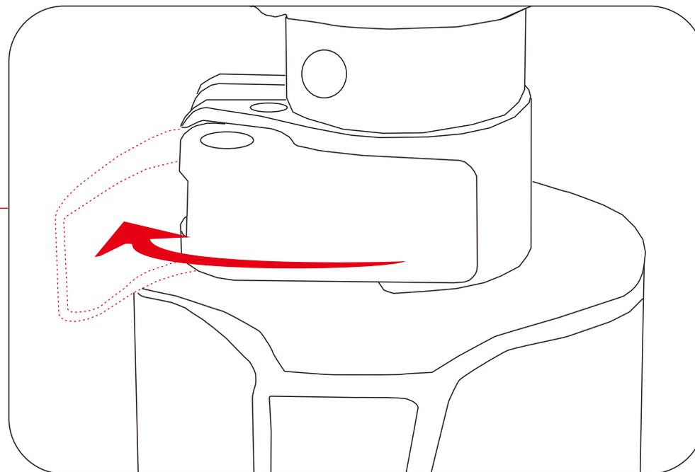
留め具を開けてからスタンドの高さを調節して、調節後にしっかり閉めます。
