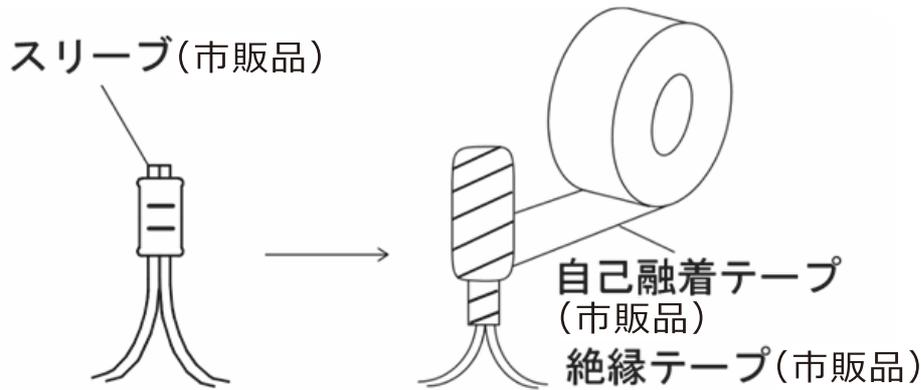
電源電線と器具口出線の接続は、スリーブと自己融着テープ・絶縁テープなどで確実に行ってください。
